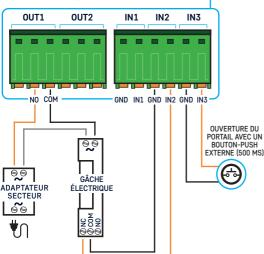
2. Câblage pour une gâche électrique simple sans interrupteur de surveillance du loquet.
