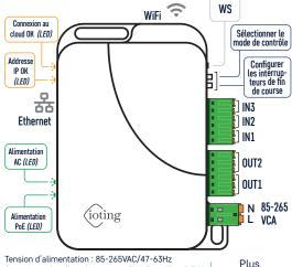
Tension d'alimentation : 85-265VAC/47-63Hz Consommation électrique : max. 5W, En veille <0.3W Tension PoE : 48V
